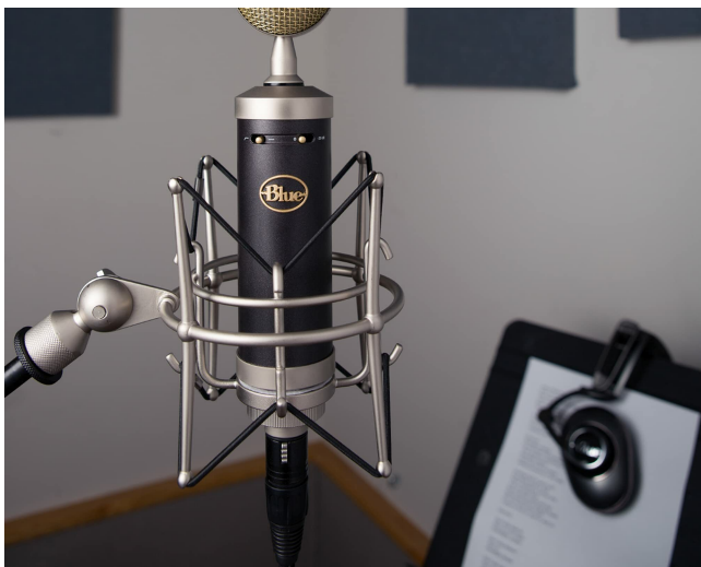
POŁĄCZENIE XLR DO KOMPUTEROWYCH INTERFEJSÓW AUDIO
