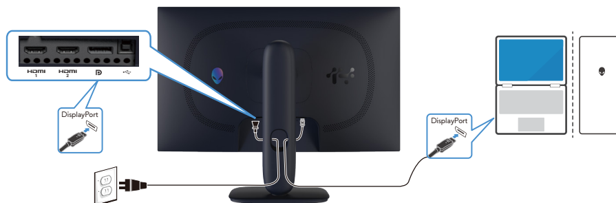
Rysunek 8. Podłączenie kabla DisplayPort (DP do DP)
