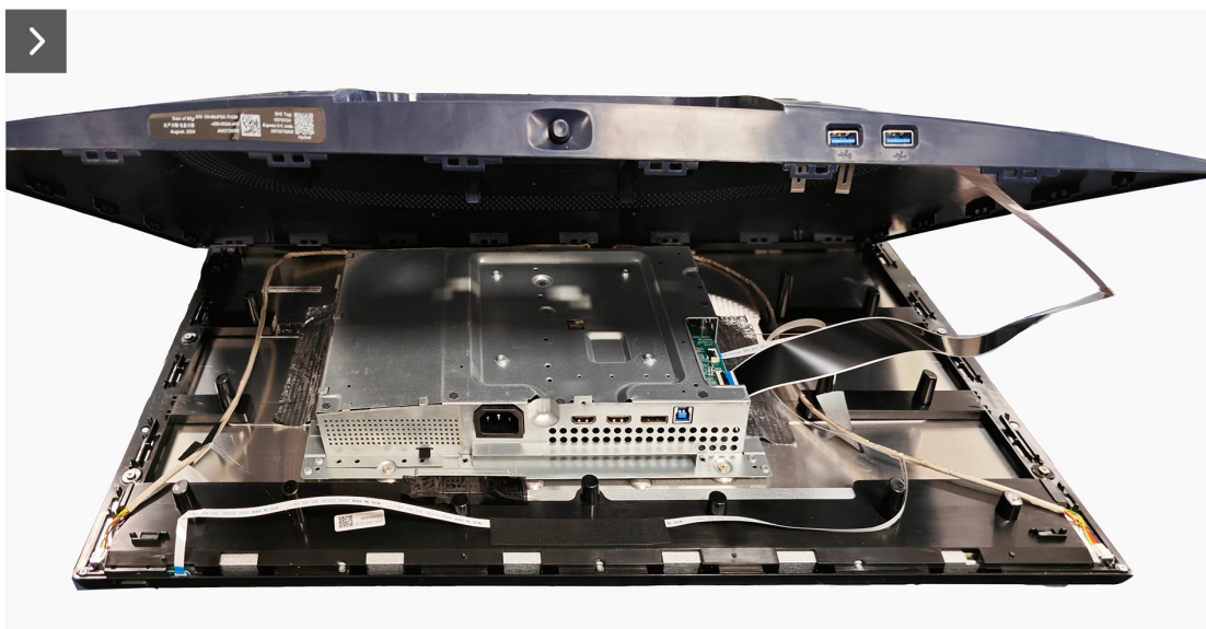
Rysunek 15. Zdejmowanie pokrywy tylnej
