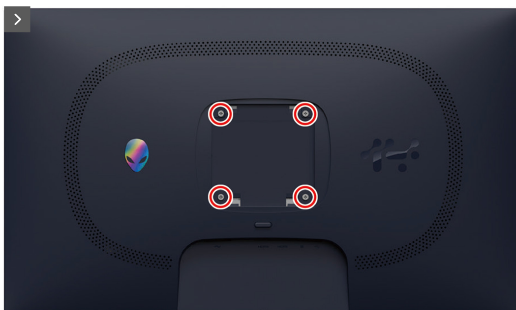
Rysunek 13. Zdejmowanie pokrywy tylnej
