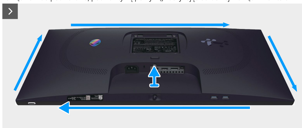
Rysunek 14. Zdejmowanie pokrywy tylnej
