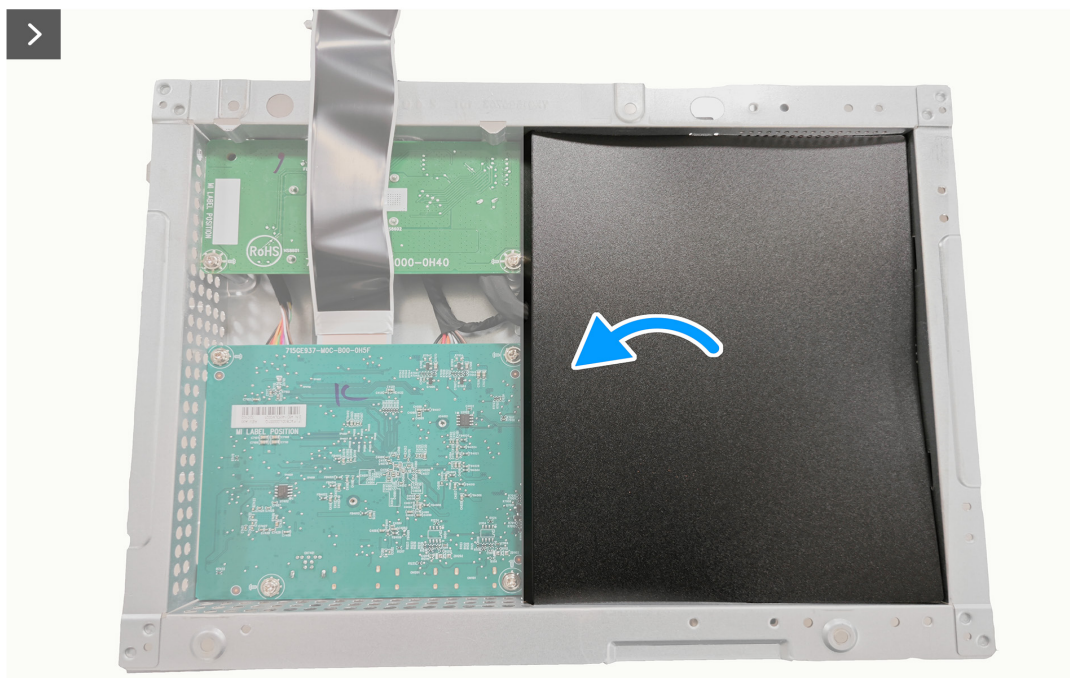
Rysunek 30. Zdejmowanie płyty systemowej i płyty zasilania
