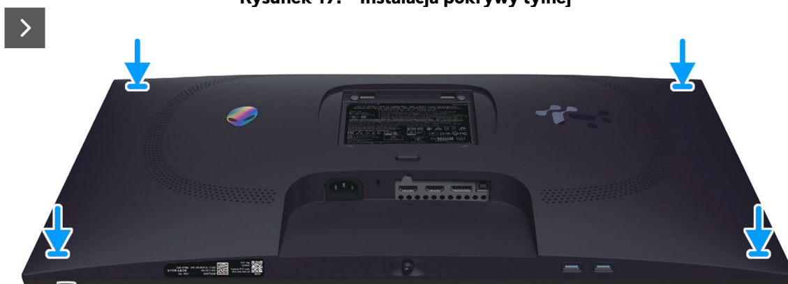
Rysunek 17. Instalacja pokrywy tylnej
