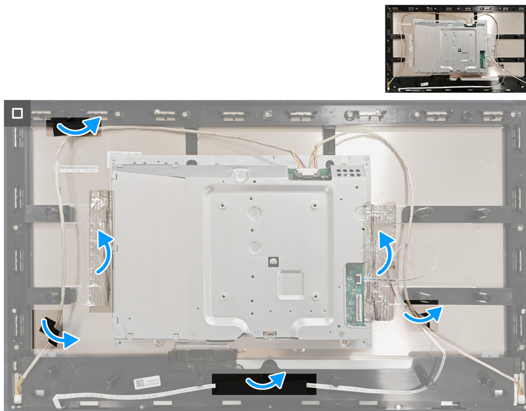
Rysunek 29. Instalacja metalowej osłony
