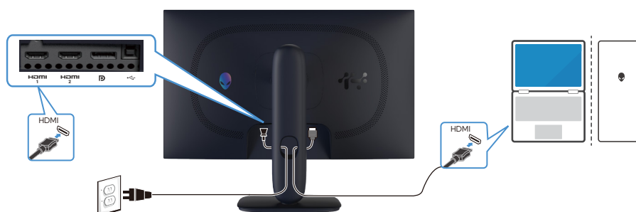
Rysunek 9. Podłączenie kabla HDMI
