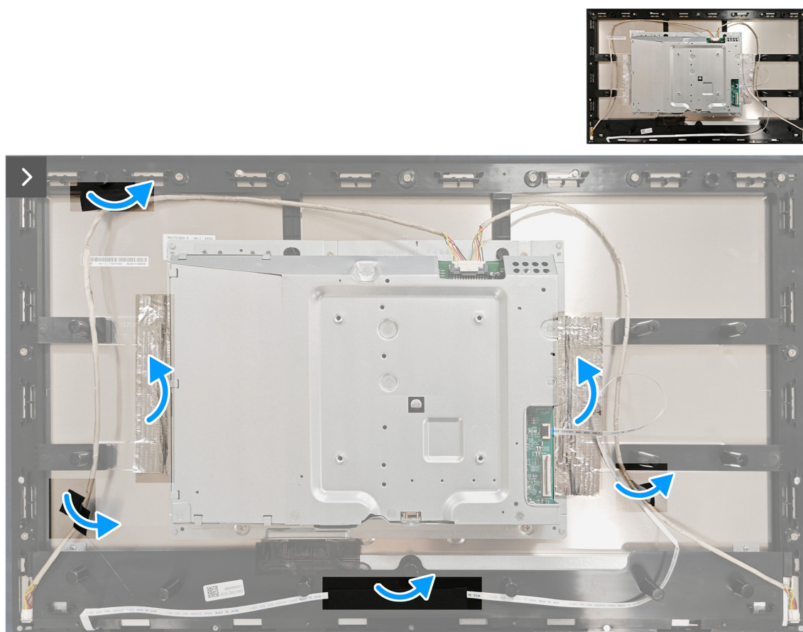
Rysunek 20. Zdejmowanie metalowej osłony
