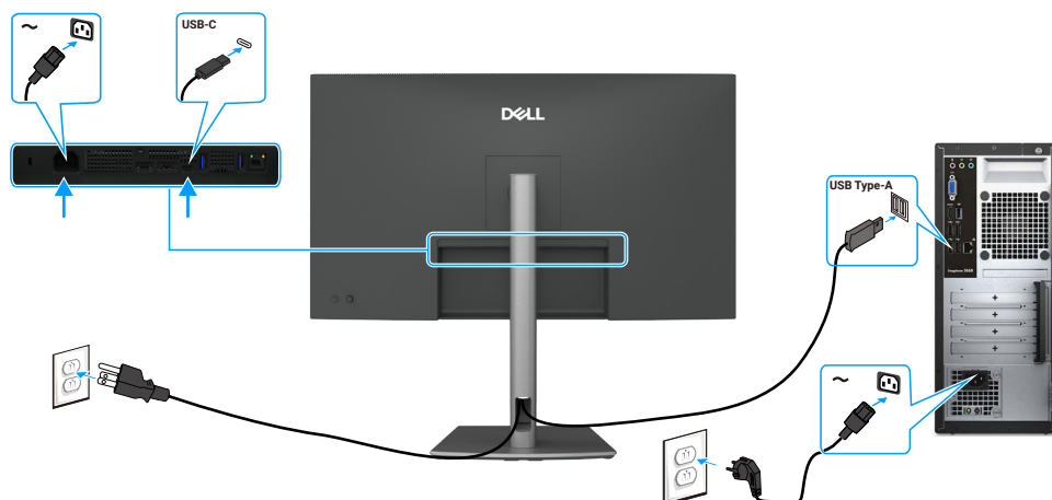
Rysunek 11. Podłączanie przewodu USB Type-C/typu A
