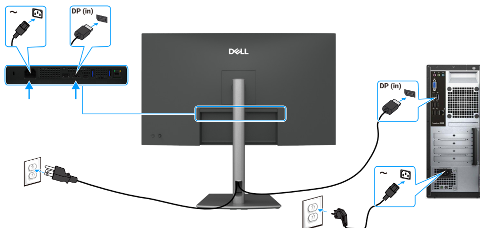
Rysunek 9. Podłączenie przewodu DisplayPort
