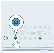
**9 Appuyez sur le bouton d'augmentation/diminution de la température et sur le bouton d'augmentation/diminution de la durée pour choisir la durée et la température souhaitées.**
