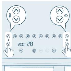
**9** Norédami pasirinkti reikiama laiką ir temperatūrą, paspauskite temperatūros didinimo / mažinimo mygtuką bei laiko didinimo / mažinimo mygtuką.
