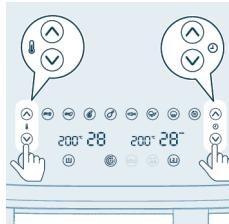
**11** Premere il pulsante di aumento/riduzione della temperatura e il pulsante di aumento/riduzione del tempo di cottura per scegliere i valori necessari.
