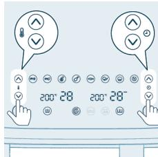
**11** Appuyez sur le bouton d'augmentation/diminution de la température et sur le bouton d'augmentation/diminution de la durée pour choisir la durée et la température souhaitées.
