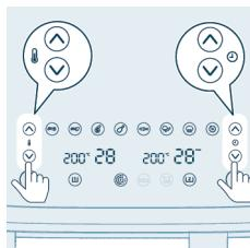
**11** Norédami pasirinkti reikiama laiką ir temperatūrą, paspauskite temperatūros didinimo / mažinimo mygtuką bei laiko didinimo / mažinimo mygtuką.
