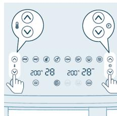
**11** Apasă butonul de creștere/reducere a temperaturii și butonul de creștere/reducere a timpului pentru a alege timpul și temperatura necesare.
