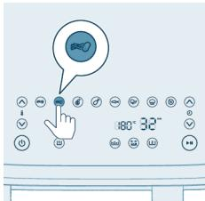
**10** Spusťte proces prípravy pokrmu stlačením tlačidla Spustiť/zastaviť.
