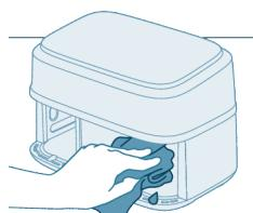
6 Исчистете ја внатрешноста на апаратот со врела вода и неабразивен сунѓер.
