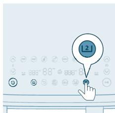
**11** Натискайте кнопку збільшення/зменшення температури і кнопку збільшення/зменшення часу, щоб вибрати необхідний час і температуру.
