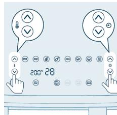
**9** Pomoću dugmeta za povećavanje/smanjivanje temperature i dugmeta za povećavanje/smanjivanje vremena izaberite potrebno vreme i temperaturu kuvanja.
