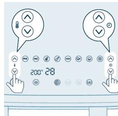
**9** Vyberte požadovaný čas a teplotu stisknutím tlačítek zvýšení/snížení teploty a zvýšení/snížení času.
