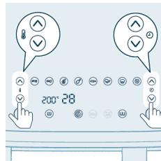
**9** A kívánt sütési idő és hőfok beállításához nyomja meg az időt és a hőfokot növelő és csökkentő gombot.
