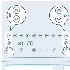
**9** Apasă butonul de creștere/reducere a temperaturii și butonul de creștere/reducere a timpului pentru a alege timpul și temperatura necesare.
