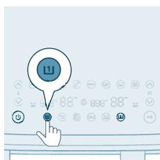
**9** Nospiediet temperatūras palielināšanas/samazināšanas pogu un laika palielināšanas/samazināšanas pogu, lai izvēlētos vajadzīgo ilgumu un temperatūru.
