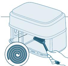
**6** Промойте внутренние части устройства под горячей водой и с использованием неабразивной губки.
