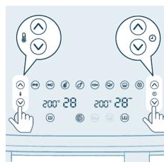
**11** Pomoću dugmeta za povećavanje/smanjivanje temperature i dugmeta za povećavanje/smanjivanje vremena izaberite potrebno vreme i temperaturu kuvanja.
