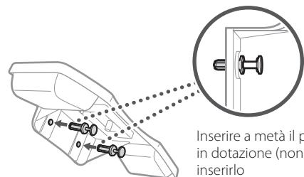
Inserire a metà il pin in dotazione (non inserirlo completamente).
