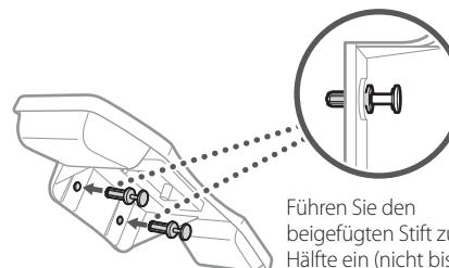
Führen Sie den beigefügten Stift zur Hälfte ein (nicht bis zum Anschlag einführen).
