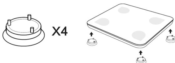
Wanneer u de weegschaal op een vloerkleed wilt gebruiken, monteert dan eerst de 4 vloerkleedvoetjes, om de nauwkeurigheid te verhogen.
