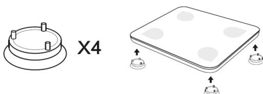
Si desea utilizar la balanza sobre una alfombra, coloque primero las 4 patas para aumentar la precisión de la medición.
