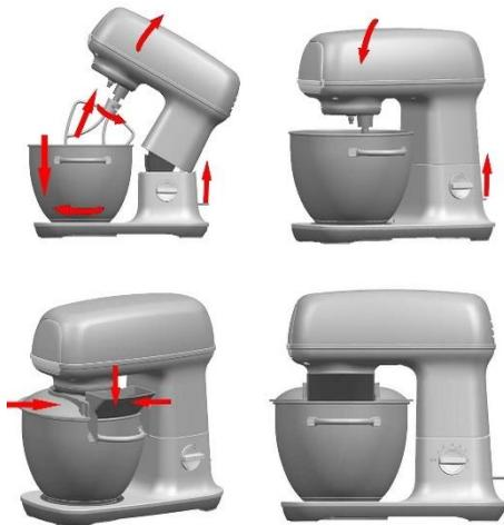
Für optimale Ergebnisse sind die Vorsätze höhenverstellbar. Je nach Art der Zutaten, können Sie die Schüssel mit Deckel (7) für die Zubereitung von ca. 1,5 Teig verwenden.
