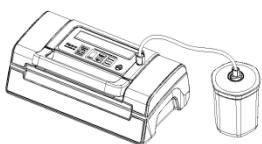
demasiada cantidad de alimento. Cierre la tapa. Fije un extremo del tubo flexible de vacío a la conexión del aparato y otro extremo a la conexión de la tapa del recipiente. Compruebe la indicación de estado LED para observar la intensidad del vacío; debe estar seleccionado el ajuste "suave" (schonend) o "normal" (normal).
