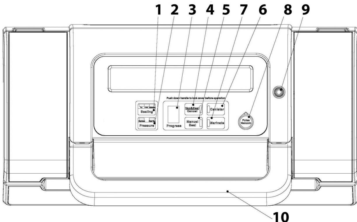
**9 Conexión del tubo flexible de vacío:** Para conectar un tubo flexible de vacío para envasar al vacío recipientes de vacío o tapones de vino.
