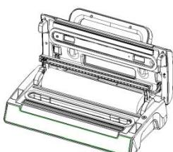
Fare attenzione che prima del taglio la lama si trovi in un lato del supporto lama e poi alzare in alto il supporto lama.
