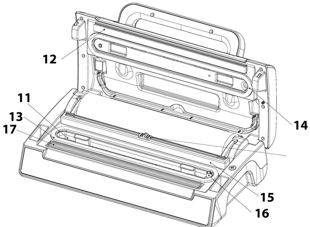
**11 Vakuumkammer:** Positionieren Sie die Öffnung des Beutels in der Kammer.
