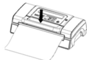
Si vous voulez arrêter le processus (peut-être que le sachet n'est pas positionné correctement), appuyez sur « **Arrêter** » (Vakuum Schweißen/Abbrechen).
