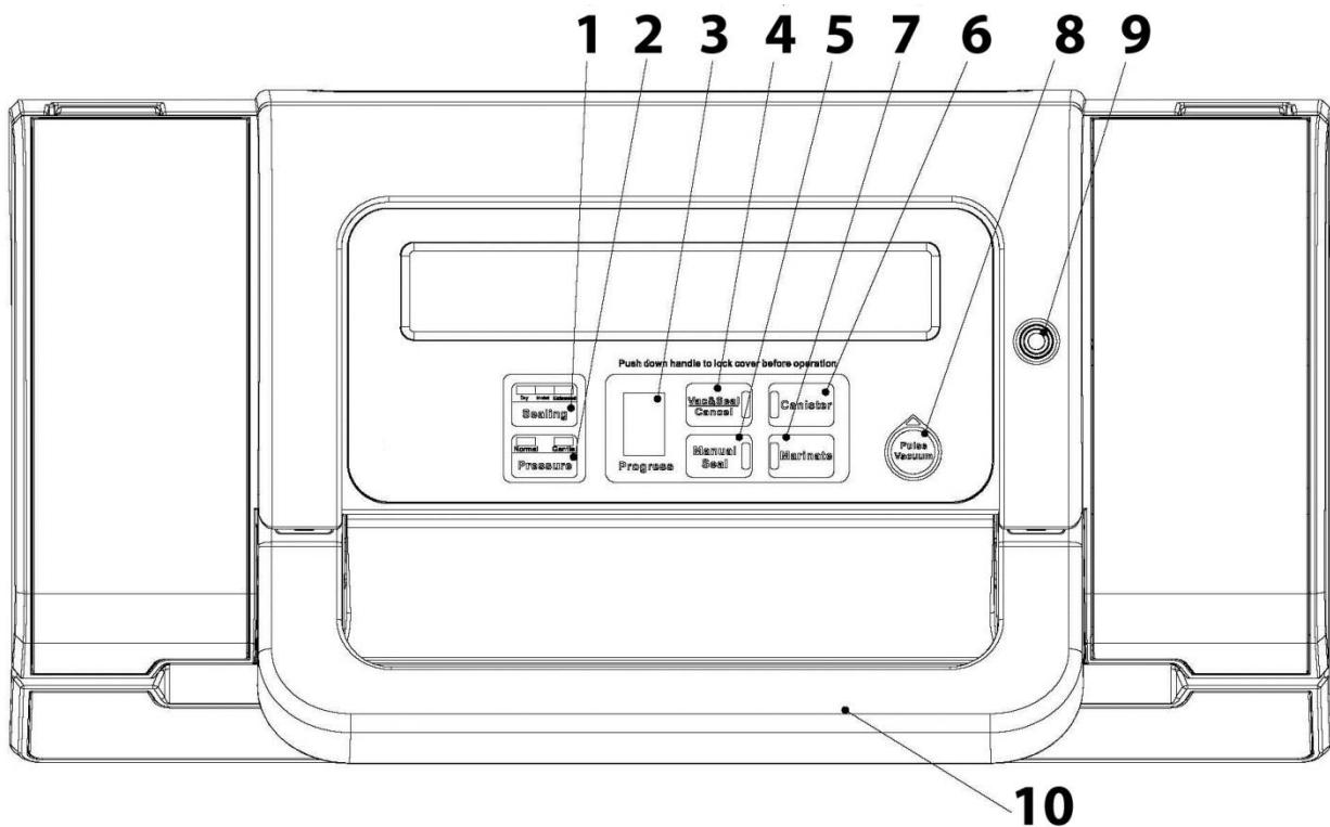
**9 Vakumschlauch-Anschluss:** Zum Anschluss eines Vakumschlauchs für das Vakuumieren von Vakuumbehältern oder Weinstopfen.
