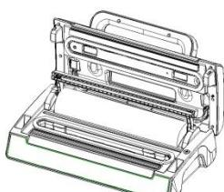
Procure colocar la cuchilla lateralmente con respecto a su soporte antes de cortar y luego despliegue hacia arriba el soporte de la cuchilla.
