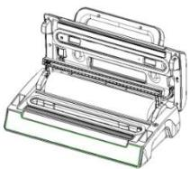
Следите за тем, чтобы нож перед разрезанием находился со стороны крепления ножа, потом откиньте крепление ножа вверх.
