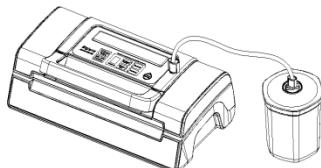
Vul het te vacumeren product in de bak. Let erop dat de bak niet te vol is. Sluit het deksel.
