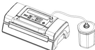
Fixez une extrémité du tuyau à l'appareil et l'autre extrémité à la connexion sur le couvercle du récipient.
