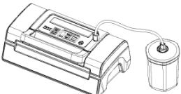
Befestigen Sie ein Ende des Vakuumierschlauches am Anschluss am Gerät und ein Ende am Anschluss auf dem Behälterdeckel.
