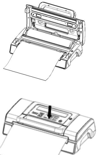
Drücken Sie den Griff wieder nach oben, öffnen Sie den Deckel und entnehmen Sie den Beutel. Dieser kann nun zum Vakuumieren benutzt werden.
