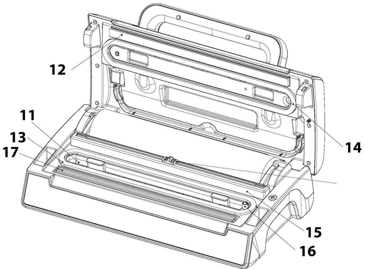
**11 Вакуумная камера:** Размещайте открытую сторону пакета в камере.
